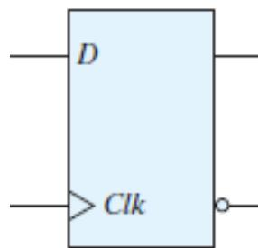
Edge triggered D flip-flop:
